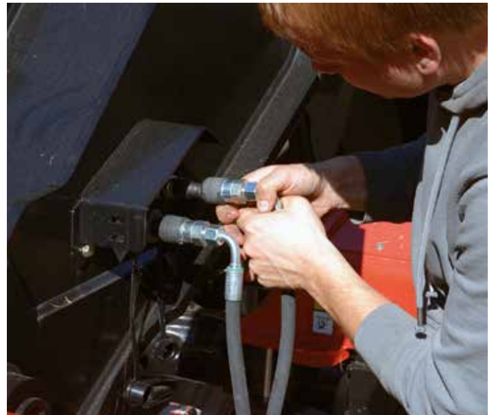
Dank Easy Connect System (ECS) lässt sich mit nur einem Knopfdruck der Druck von den Leitungen nehmen und der Hydraulikwechsel wird zum Kinderspiel.
