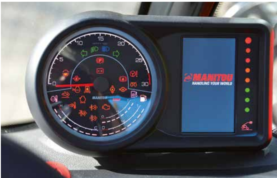
Das große Harmony-Display informiert über alle Funktionen und verrät zum Beispiel auch, wenn eine angezogene Handbremse die Fahrt verhindert.
