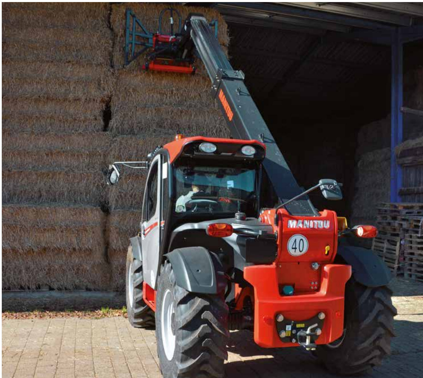
Mit einer Reichweite von über 6 m lassen sich die Ballen hoch stapeln, sodass wenig Bodenfläche benötigt wird.
