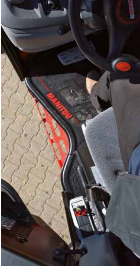
Eine Aussparung sorgt dafür, dass der Fahrer den Tritt leicht erreichen und bequem ein- und aussteigen kann.
