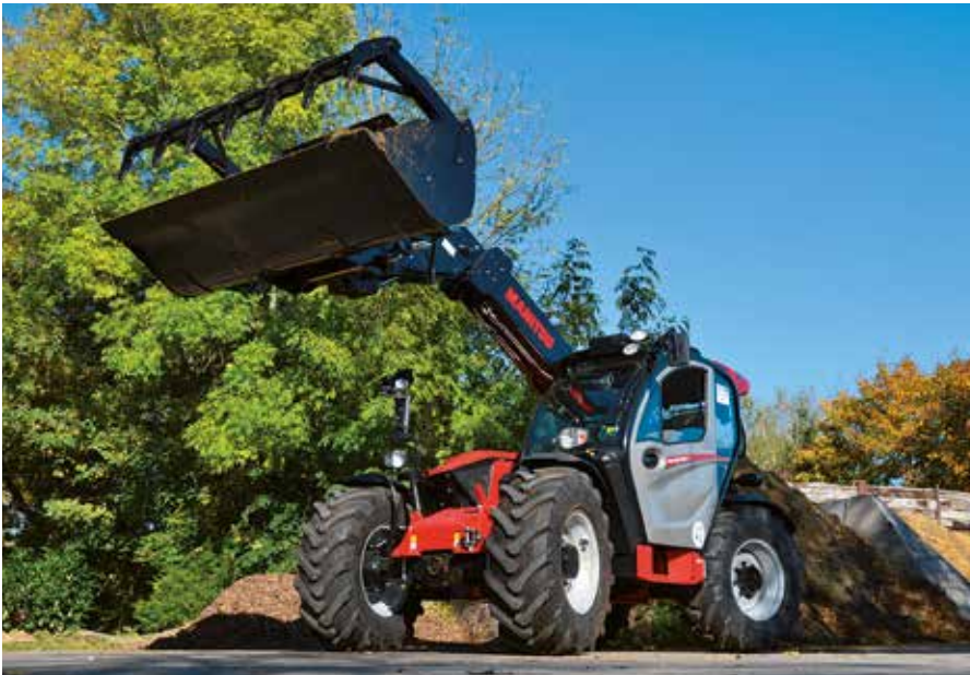
Mit dem Drehknopf links neben dem Fahrersitz wird die Lenkart festgelegt. Zur Auswahl stehen Hundegang, Allrandlenkung und klassische Vorderachslenkung.
